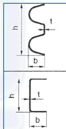
Det særlige profil sikrer maksimal styrke ved påkørsel. Monteringsboltene sidder placeret i profilets dybeste del, og kommer således ikke i berøring med passerende trafik.
